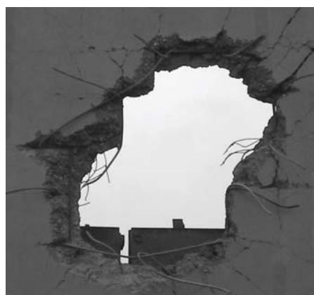
Ефекат дејства два пројектила на зид од армираног бешона – већа димензија отвора је 1.250 mm, а мањег, на најужем делу, око 700 mm
