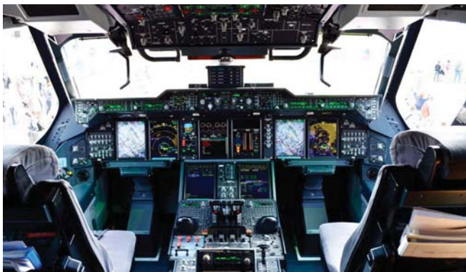
Кабински простор авиона А400М сличан је кабинци путничког јамбо-џета А380 (Фото Airbus Military)
